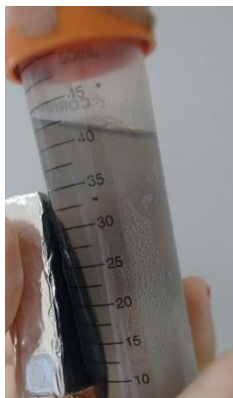
Figura 1: Separação magnética das nanoestruturas de ferro metálico sintetizadas nos poros da MCM-41 (NPF e /Si) Fonte: Elaborada pelo autor
